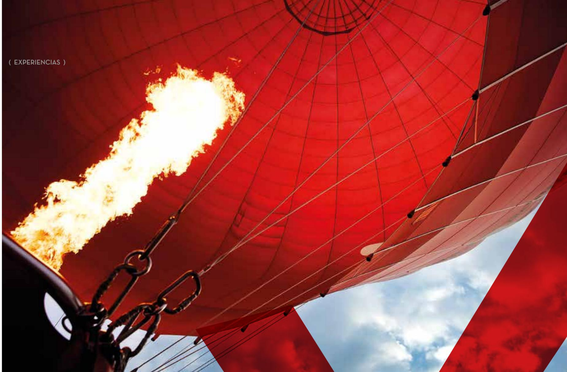
El inflado consta de dos etapas: primero aire frío con un gran ventilador y, después, aire caliente con un quemador de propano en la envoltura parcialmente inflada.
